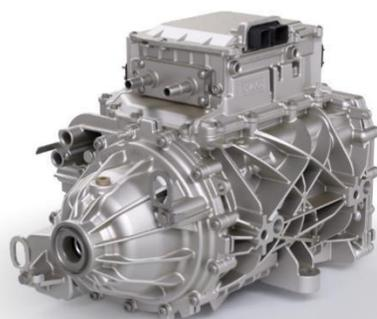
iDM 配有博格华纳变速箱，可与其他供应商的电机和电力电子设备集成，集中体现公司在系统集成方面的广泛知识。
