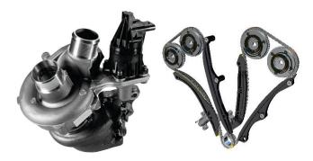
Turbolader, VCT-Versteller und Nockenwellenantriebssysteme tragen zur hohen Effizienz und Leistungsfähigkeit bei, die die zweite Generation des 3,5 Liter starken Ford EcoBoost<sup>®</sup>-Motors liefert.
