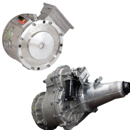
Le moteur électrique HVH250 et la boîte de vitesses eGearDrive® de BorgWarner propulsent le lancement initial du FUSO eCanter, premier petit camion de série 100% électrique au monde.
