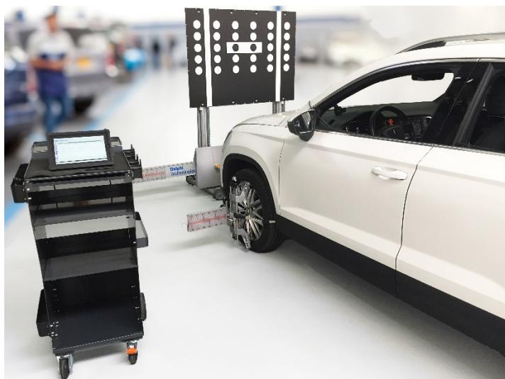
Il nuovo kit ADAS espande ulteriormente le capacità diagnostiche di Delphi Technologies
