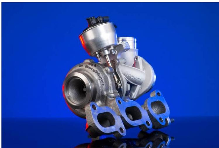
Projetado para melhorar a economia de combustível e reduzir as emissões, o turboalimentador VTG da BorgWarner eleva o desempenho do motor 1.4 de três cilindros recentemente desenvolvido pelo Grupo Volkswagen.
