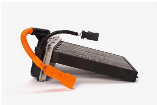
博格华纳为蔚来 ES8 电动 SUV 提供的先进高压座舱加热器 (PTC) 在带来舒适驾驶体验的同时提升
